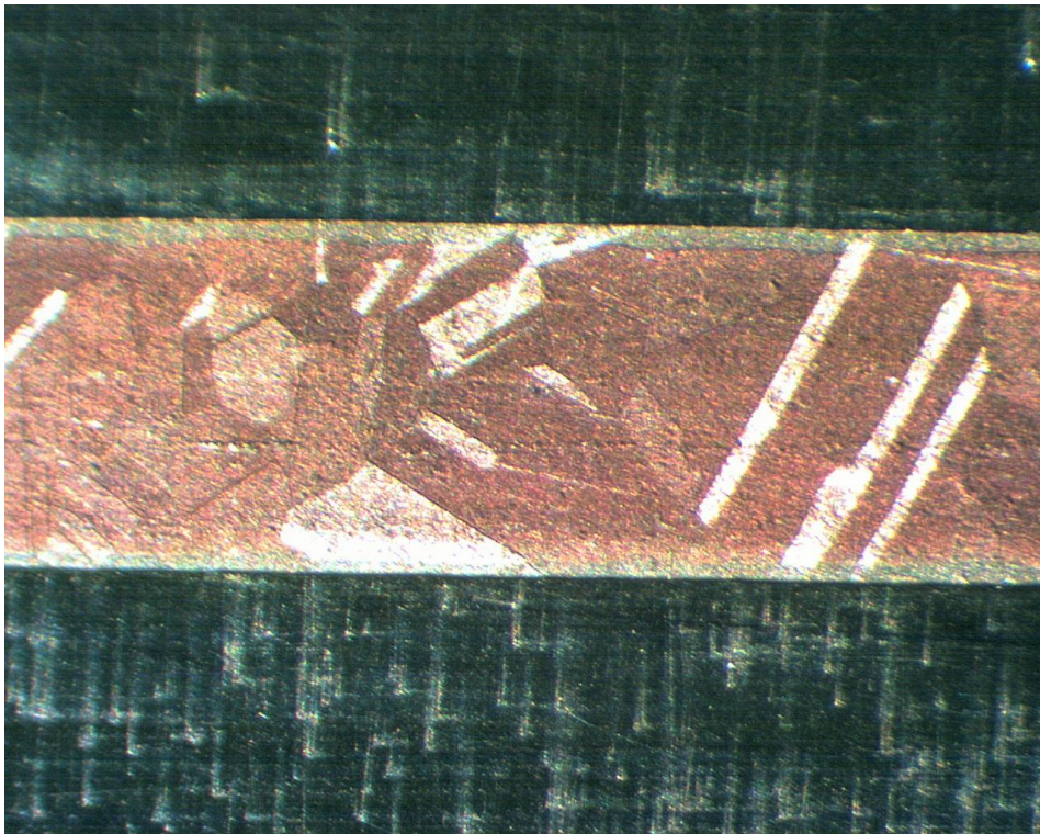
Gefügestruktur im Auslieferungszustand Ag1000/Cu99
