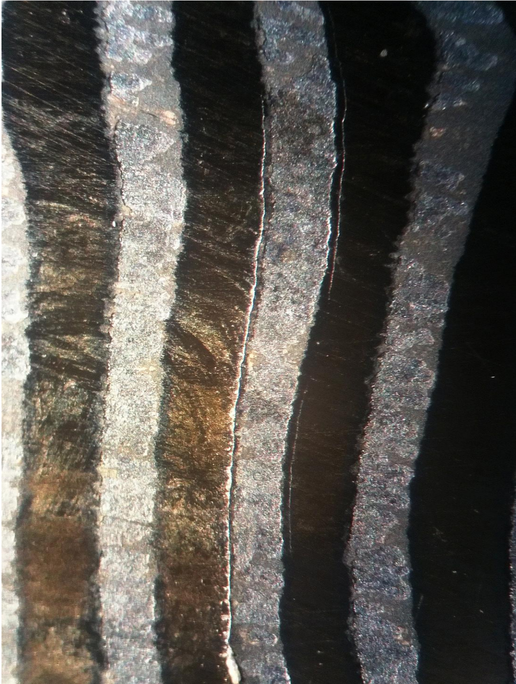
Bruchzone einer überlasteten Kombination Pd500/Gg750. Bruchverlauf innerhalb der Au750 Lage nahe den Mittellagen
