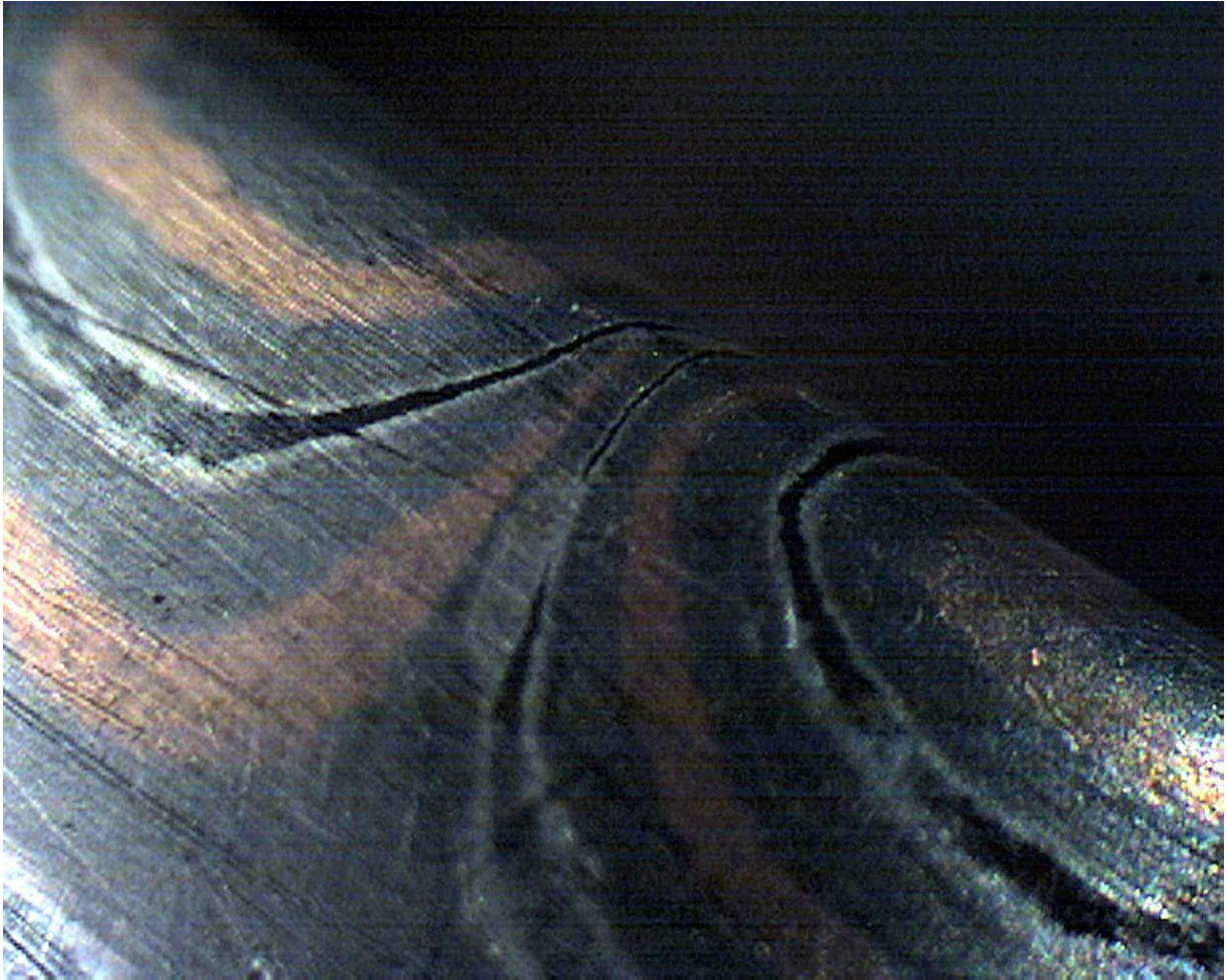
Großaufnahme vermeintlicher Risse in einem Ring aus Pd500/Rg585/Ag935
